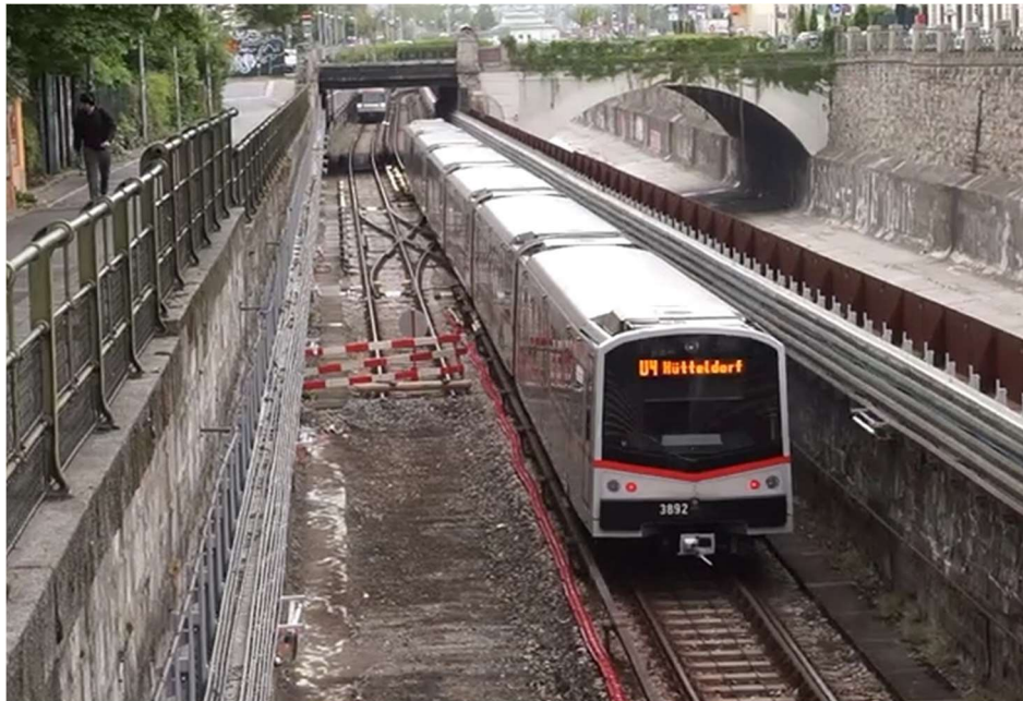
Foto 43 - Tra Pilgramgasse ( chiusa ) e Margaretengürtel della U4, c'è lo scambio di accesso al tratto a binario unico. Qui un treno diretto in periferia sta per liberare il binario all'altro treno in attesa al segnale
